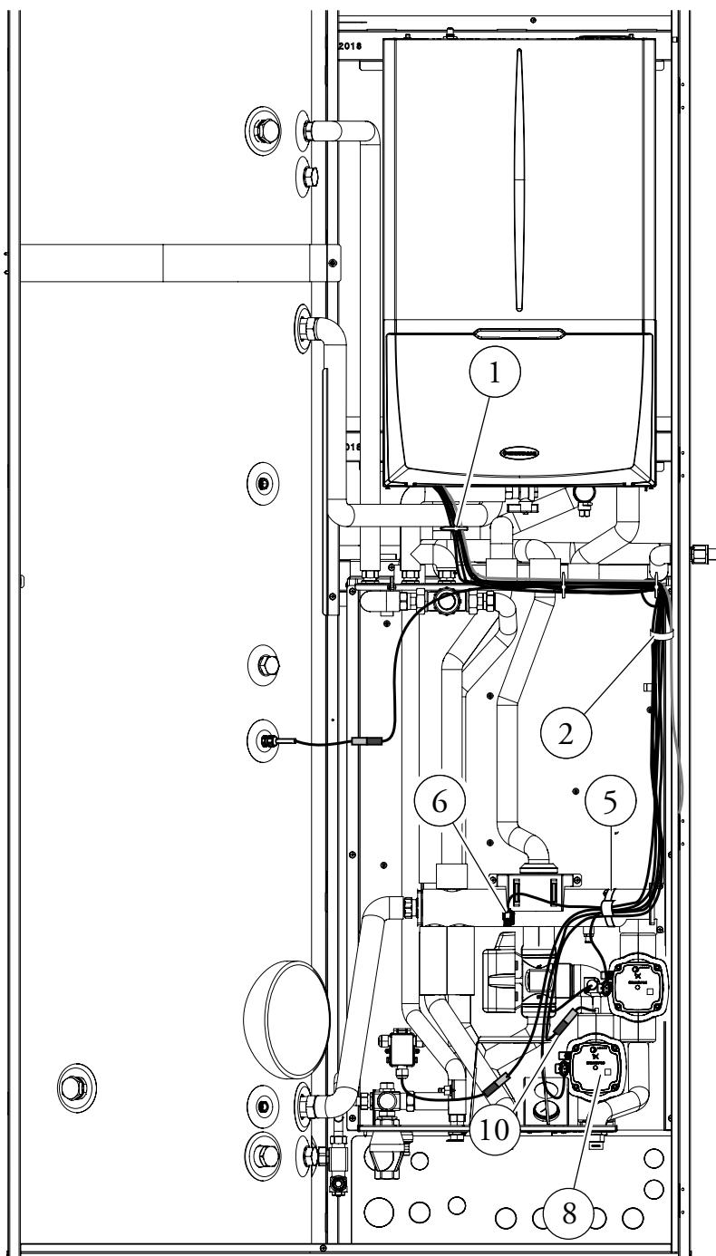
Una volta effettuato l'assemblaggio del kit procedere alla cablatura secondo quanto rappresentato nello schema elettrico sul libretto istruzioni.
