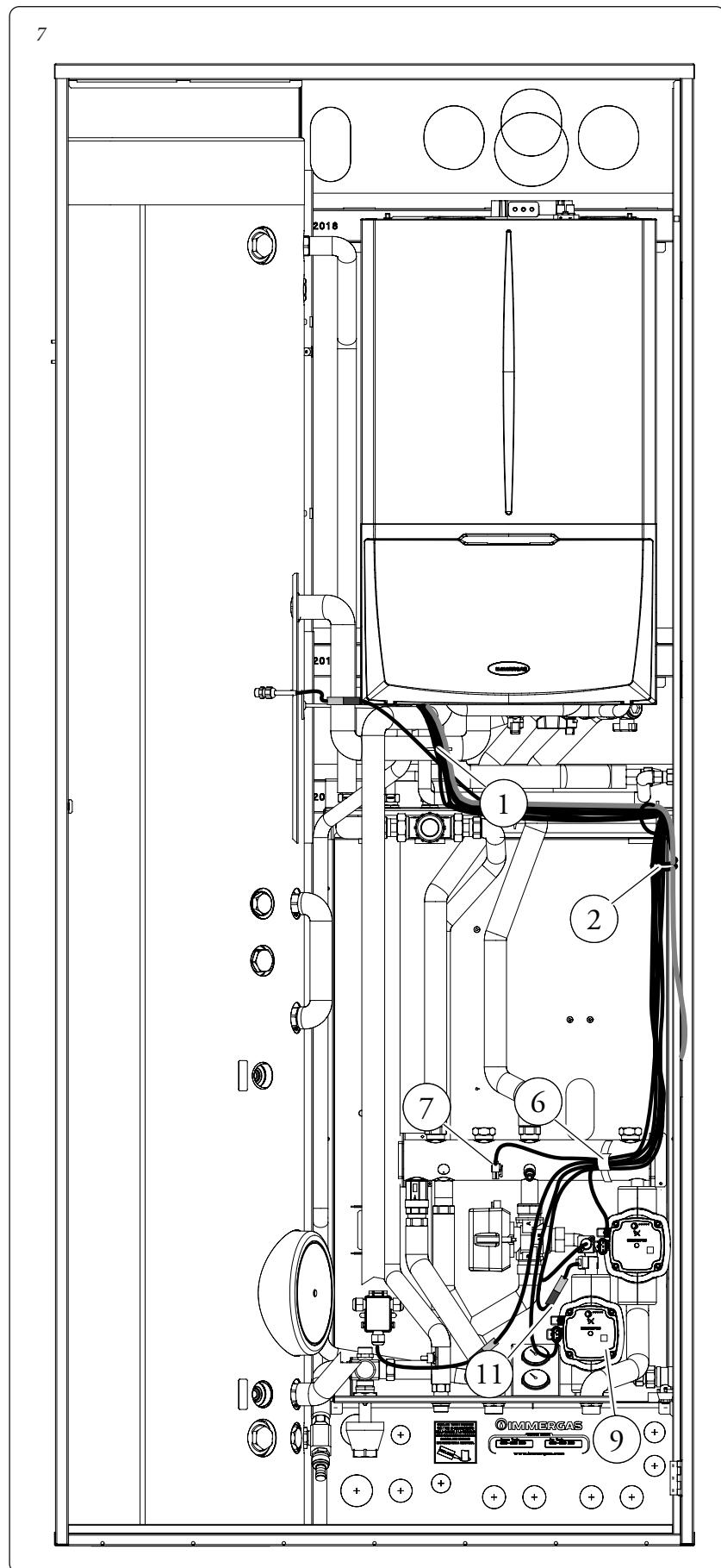
Una volta effettuato l'assemblaggio del kit procedere alla cablatura secondo quanto rappresentato nello schema elettrico sul libretto istruzioni.
